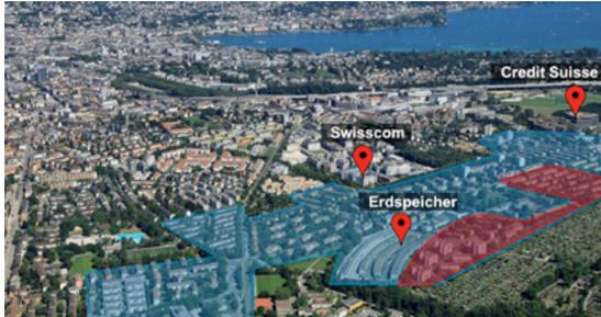
**Abbildung 1** Gebiet der Familienheimgenossenschaft Zürich, welches bis 2030 mit einem „Anergienetz“ versorgt werden soll (rot: bereits realisiert). Die Abwärme stammt hauptsächlich aus zwei Rechenzentren.
