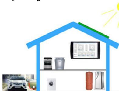
**Abbildung 1:** Gebäude mit Eigenverbrauchsmanager und betrachtete Komponenten wie Photovoltaikanlage, Wärmepumpe, Brauchwarmwassererwärmer, Elektromobil (Plug-In-Hybrid) und Haushaltgeräte.
