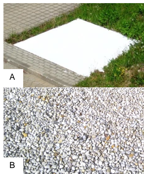
Abbildung 6: Albedo Test-Untergründe - A: weiß getünchter Beton, B: weißer Kiess.
