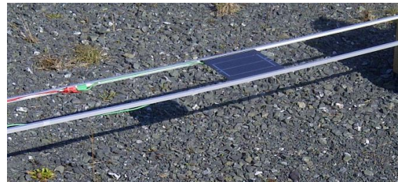
Abbildung 5: Testaufbau für Albedo Messung mittels Solarmodul.
